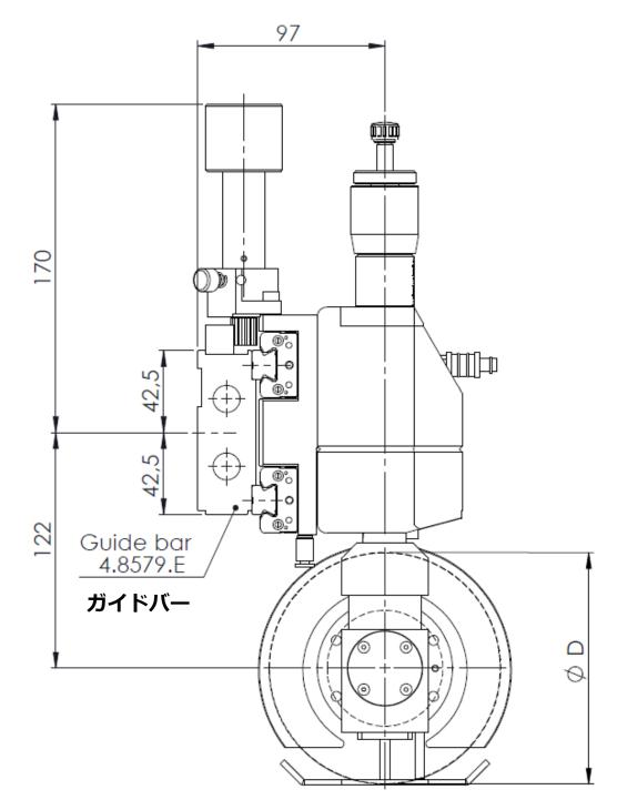
紙 400 gr/m2 まで プラスチック・フィルム  $25\mu \sim 500 \mu$  不織布 500 gr/m2 まで 最大スピード 1000 m/min 最小スリット幅 40 mm
